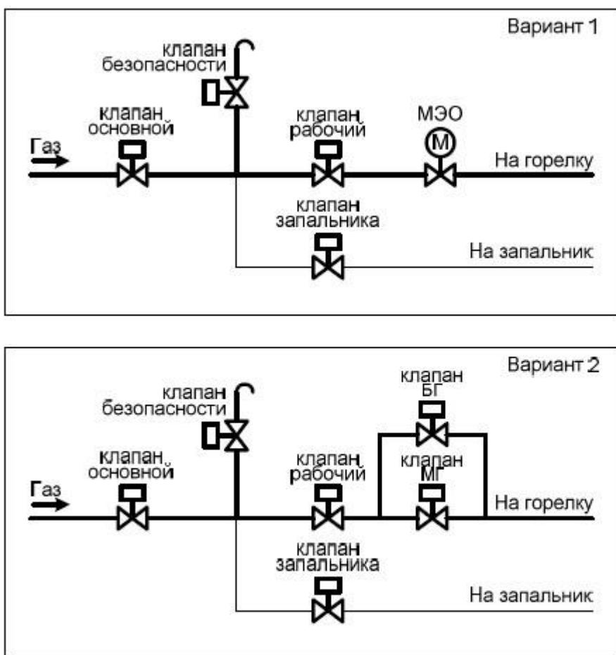
Регулирование мощности производится по соотношению давлений «газ-воздух», «газ-разрежение», клапанами большого (БГ) и малого (МГ) горения, по сопротивлению реостатного датчика МЭО.
